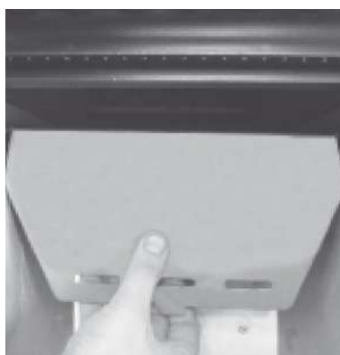
Fig. 16: rotação do defletor de chama
