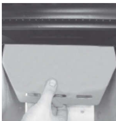
Fig. 16: rotación de el deflector
