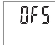
Por ejemplo, si el aparato está ajustado a 20°C y el termómetro de la habitación indica 18°C, la desviación debe ser -2°C.
