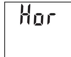
Eğer ⓧ simgesi kalıcı olarak program modunda (**Pro** veya **EcP**) yanıp söñüyorsa, bu bir elektrik kesintisinden sonra saatin denkleştirdiğini gösterir. Eğer süre ayarlanmamışsa yanıp söner.
