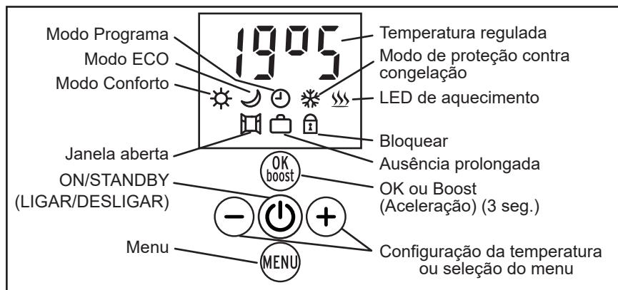
O ícone e o valor a ser ajustados piscam. Deixam de piscar quando a configuração for validada premindo **OK-boost**, ou após 30 segundos de inação (qualquer modificação à configuração é, nesse caso, cancelada).
