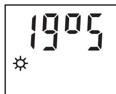
Când este în funcțiune modul Confort (**Con**), apăsați pe butonul + sau - pentru a crește sau a reduce temperatura presestată; temperatura apare intermitent.
