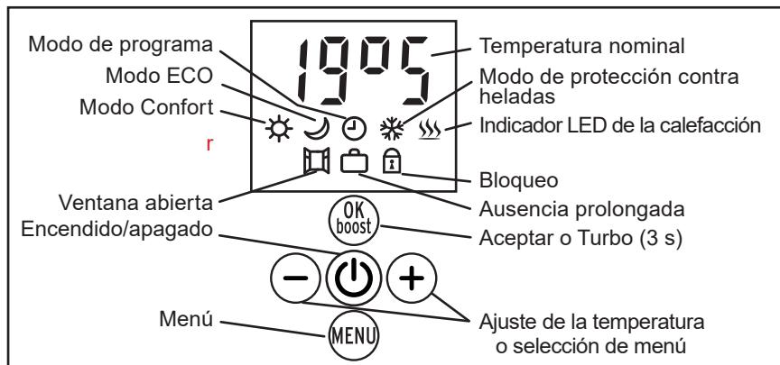
*El símbolo y el valor que se está ajustando parpadean. Dejan de parpadear cuando se confirma el ajuste pulsando OK-boost, o al cabo de 30 segundos de inactividad (en ese caso, se cancela cualquier modificación del ajuste).*
