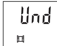
*Pozitia manuala (**ΠAn**) pune radiatorul in modul de protecție la îngheț timp de o oră. În timpul acestei ore, se pot restabili setările inițiale prin apăsare pe **MENU**. Pictograma este afișată intermitent când se detectază o fereastră deschisă. Atunci când este detectată o fereastră deschisă, radiatorul încălzește timp de câteva minute la fiecare jumătate de oră, pentru a verifica dacă fereastra s-a închis.*
