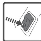
Coloque o interruptor da ignição em "O"
