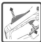
Solte o bloqueio do acelerador (2) e o acionador do acelerador (3)
