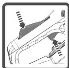
Prima o bloqueio do acelerador (2) e o acionador do acelerador (3) para cancelar o funcionamento rápido
