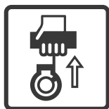
Tirar del mango de arranque manual x4 (la máquina todavía no debe arrancar)
