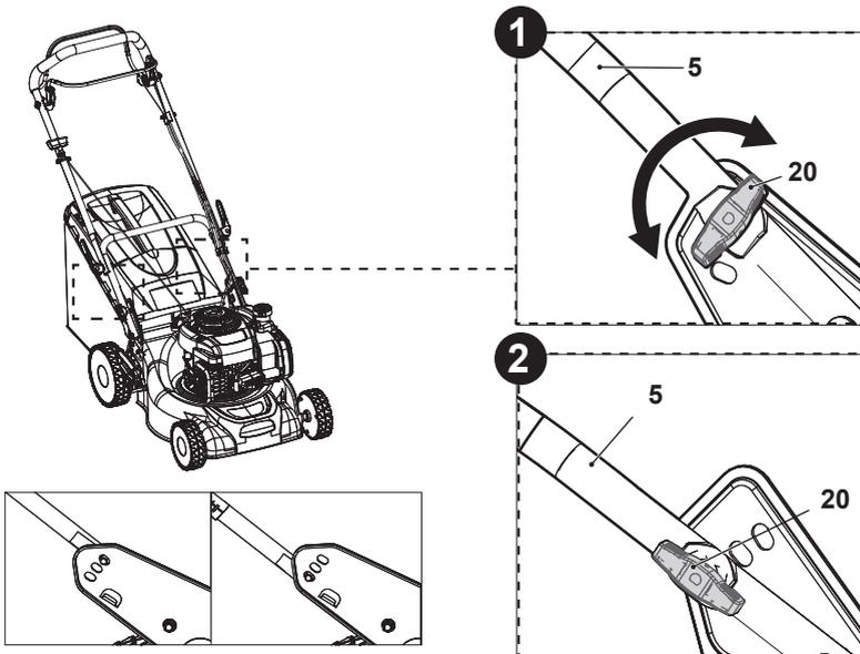
5. Despliegue el agarradero superior (4) y sujételo con el freno de embrague (3) mirando hacia arriba. Alinee los agujeros de montaje del agarradero superior (4) y el agarradero inferior (5) (Fig. 3).
