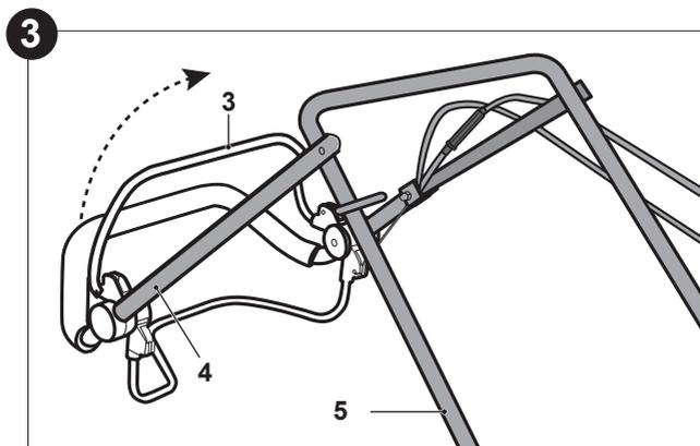
6. Fije el agarradero superior (4) al agarradero inferior (5) pasando las palancas laterales (8), las arandelas (8a) y los tornillos (8b) por los agujeros de montaje (Fig. 4). Enrosque la palanca lateral (8) en el sentido de las agujas del reloj y bloquéela doblándola hacia el agarradero. Si no consigue doblar la palanca lateral (8), aflójela y vuelva a doblarla (Fig. 5). Si está demasiado floja, apriétela oscilando la palanca lateral (8).
