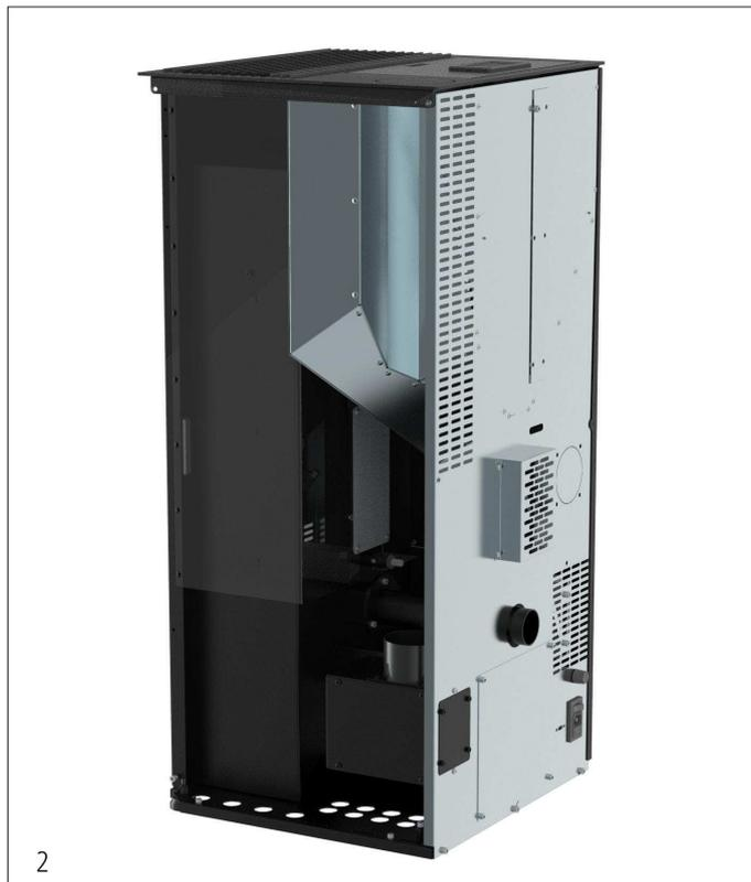
En los modelos 12 y 12C existe la posibilidad de conectar la salida de humo vertical. Retire la placa que cierra la salida vertical moviéndola a la salida trasera e instale la boquilla de 80 mm de diámetro que retiró en la parte superior de la caja de humos.
