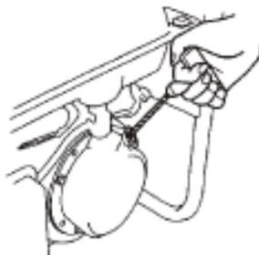
Alinee la muesca en la polea de arranque con el orificio en la parte superior de la manija.
