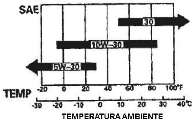
Use aceite de 4 tiempos, o detergente alto equivalente, aceite de motor de calidad superior certificado para cumplir o exceder los requisitos del fabricante de automóviles de EE. UU. Para la Clasificación de servicio SG, SF/CC, CD. Los aceites de motor clasificados SG, SF/CC, CD mostrarán esta designación en el contenedor.
